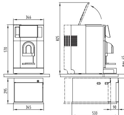
Unterstellkühleinheit unter Maschine
